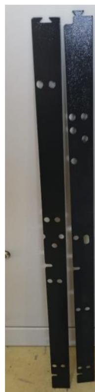
**Рис. 15. Стыковка корпусов при помощи пластин**
